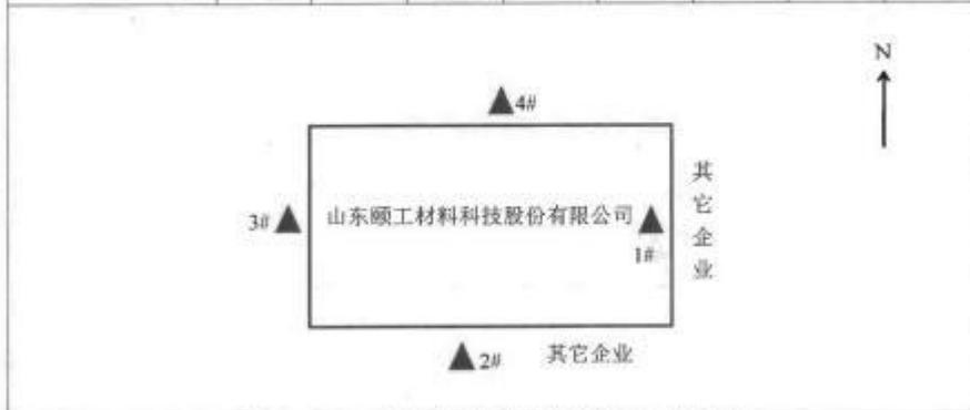
图 5 ASA 工程塑料新材料生产噪声检测布点图
